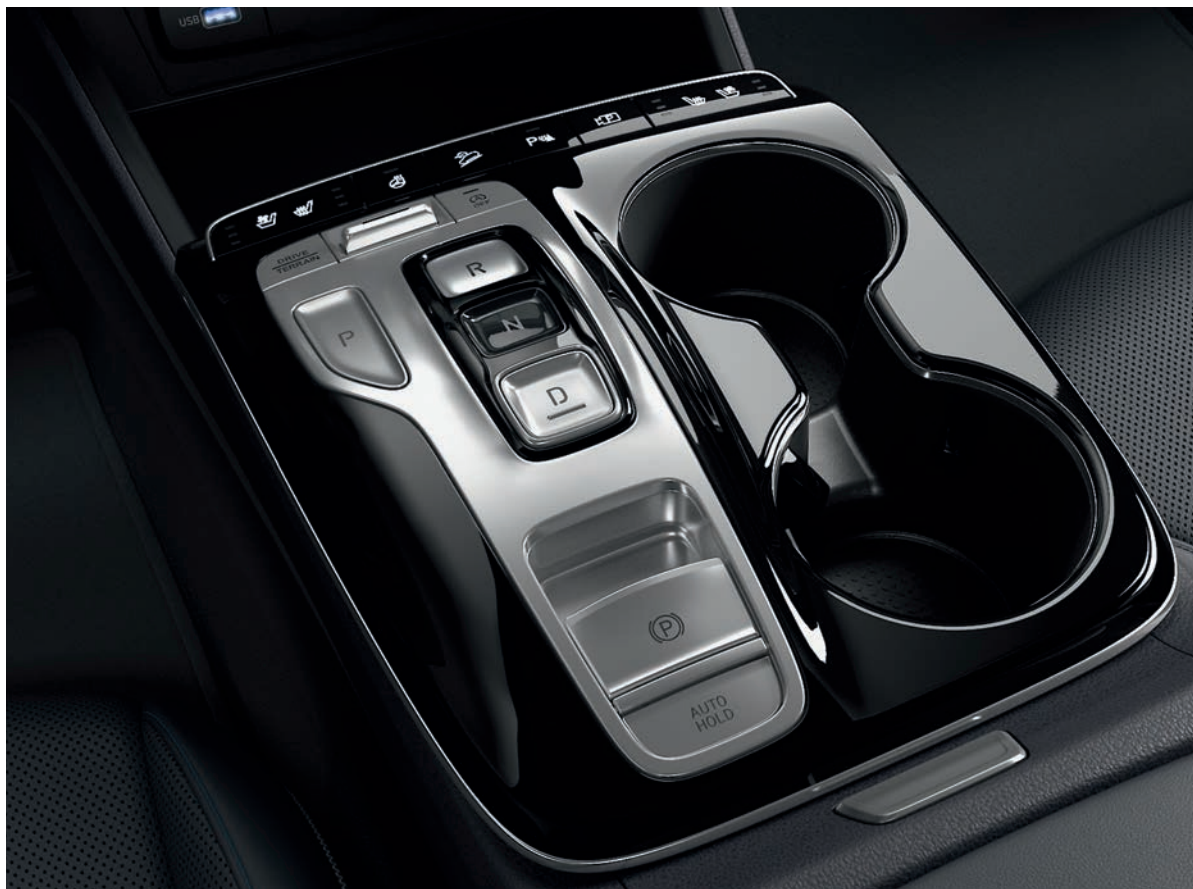
Elektronické ovládání převodovky tlačítka „Shift by Wire“.
